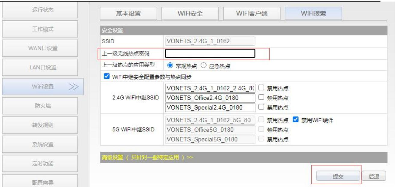
4. 点击系统设置按钮，重启模块，重启过后：VONETS 模块会自动连接已配置的 WIFI 热点，若连接成功，它的 WIFI 状态灯会快速闪烁；（指示灯说明请参照备注 1）
